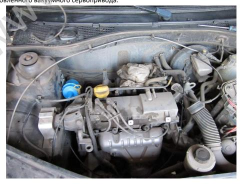
3.2.5 Подсоединяем тросик сервопривода к тросу педали акселератора соответствующими зажимами из комплекта, проводим предварительную регулировку, чтобы свободный ход троса сервопривода был меньше рабочего хода троса акселератора и чтобы исключить перетирание троса сервопривода об крепление троса акселератора.
