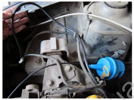
Механическая часть установки вакуумного сервопривода окончена.
