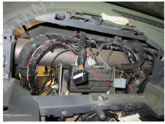
Надёжно закрепляем провода стяжками и устанавливаем на место приборную панель.
