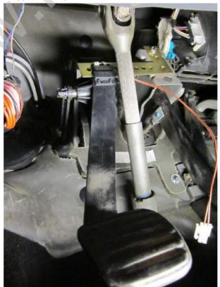
3.3.3 Снимаем с крепления концевой выключатель сигнала тормоза. Для этого просто проворачиваем его против часовой стрелки приблизительно на 90° и легонько тянем на себя. В разъеме, на желтом проводе появляется +12В после включения зажигания, на оранжевом проводе +12В при включенном зажигании и отжатом положении концевого выключателя. Подсоединяем к оранжевому проводу любой из коричневых проводов датчика сцепления. Второй конец необходимо подсоединить к коричневому проводу модуля управления.
